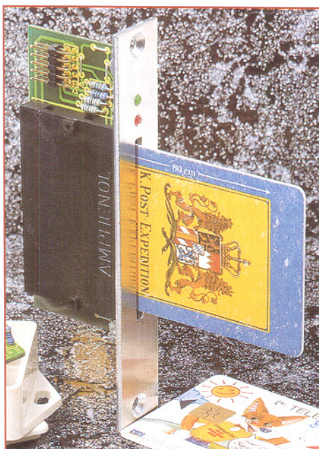
Bild 18: Sichere Sache - Ein Magnetkartenschloß bietet wenige Angriffspunkte für Einbrecher.
