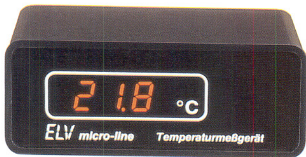
Bild 1: Der Beginn der Fernmeßtechnik: Thermometer mit zusätzlichem Außenfühler.
