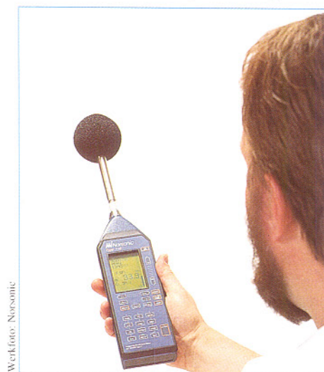
Bild 5: Beispiel für einen integrierenden Schallpegelmesser, mit dem auch zeitlich gemittelte Schallpegel gemessen werden können - für Messungen im Umweltschutz unentbehrlich.
